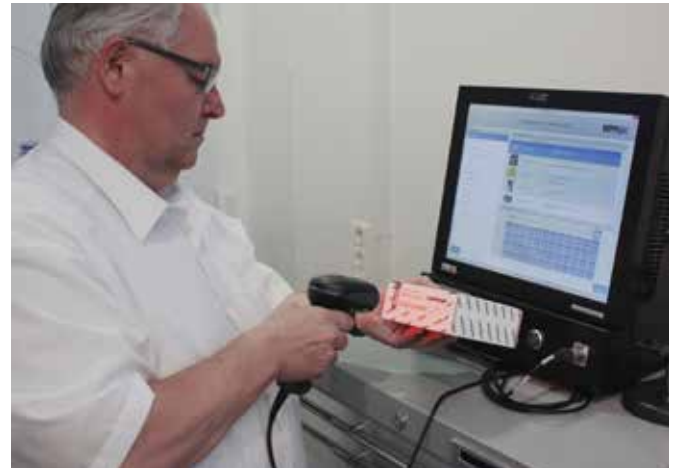
Per Barcode-Scanner werden Waren in das System eingelesen. Der TSM® kontrolliert den Lagerbestand, bestellt selbstständig und verhindert so etwa Maschinenstillstandzeiten.
