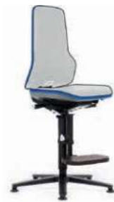
Arbeitsstuhl Neon mit Gleiter und Aufstiegshilfe Höhenverstellbereich mit Gasfeder von 590 – 870 mm, Synchronmechanik, ohne Polster
