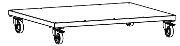
Fahrbarer Ablageboden ohne Trennbügel 4 Lenkrollen Ø 100 mm, davon 2 Stk. gebremst, Höhe 165 mm, Tragkraft bis 50 kg
